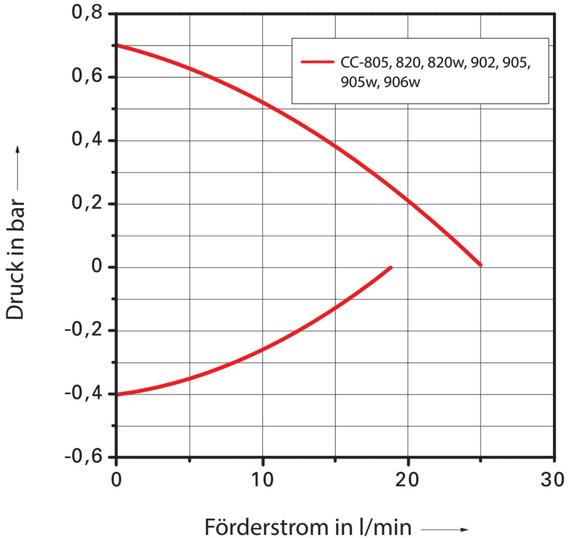
Messung erfolgte nach DIN 12876 mit Wasser bei 20° C
