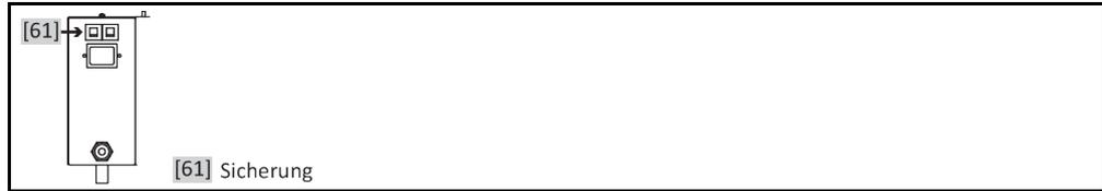
An der Rückseite befinden sich die thermischen Überstrom-Schutzschalter für allpoliges Abschalten (L und N). In einem Fehlerfall (keine Funktion und/oder keine Anzeige) prüfen Sie bitte zuerst, ob die Überstrom-Schutzschalter ausgelöst haben. Sollten die Überstrom-Schutzschalter nach Reversierung unmittelbar wieder auslösen, ziehen Sie bitte den Netzstecker, und setzen Sie sich bitte unverzüglich mit dem Customer Support in Verbindung. → Seite 32, Abschnitt »Kontakt Daten«.
