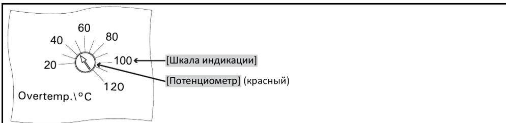
Защита от перегрева предусмотрена только в термостатах, оснащенных системой нагрева. Контроль предпусковой температуры обеспечивает безопасность Вашей системы. Он настраивается непосредственно после заполнения системы теплоносителем.
