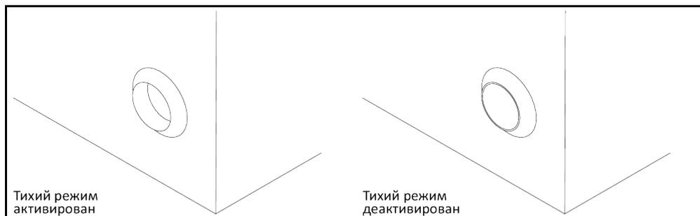
Если на термостате активируется тихий режим, уровень шума снижается за счет уменьшения мощности насоса. Точное положение выключателя **>Изменение числа оборотов насоса<** [114] указано в схеме подключения. → См стр. 60, раздел **»Приложение«**.
