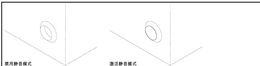
激活温度控制器上的低音模式后，由于泵机功率降低，声压级也相应降低。>更改泵转速< [114] 开关的具体位置参见连接示意图。→自第 54 页，章节 »附录«。
