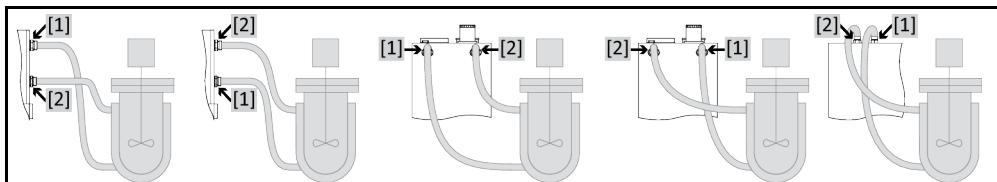
为使您的应用仪器能够正常工作且系统中没有气泡，温度控制器的 >循环出口< [1] 接口必须与应用仪器上位置较低的接口连接而温度控制器的 >循环入口< [2] 接口必须与应用仪器上高度位置相同或更高的接口连接。对于不带>膨胀容器< [18]的温度控制器，应确保应用的下方连接点与>循环入口< [2] 接口处于同一高度或略高于同一高度。
