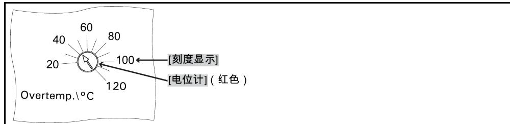
过温保护仅安装在具有加热装置的温度控制器中。监控预流温度是为了系统安全。同样在对系统加注导热液后进行设置。
