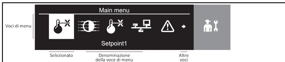
Il menu principale viene richiamato premendo contemporaneamente i >tasti a freccia< [B]. A seconda della dotazione del termoregolatore utilizzato, alcune voci di menu non sono selezionabili.
