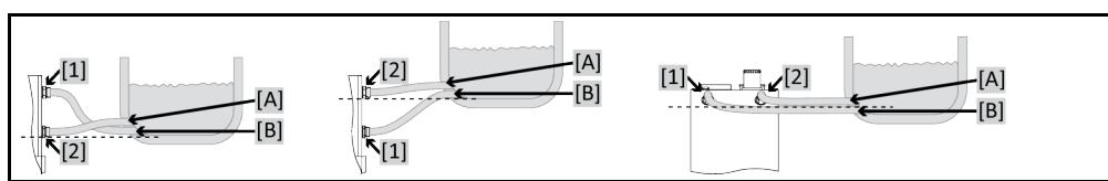
为使您的应用仪器能够正常工作且系统中没有气泡，温度控制器的 >循环出口< [1] 接口必须与应用仪器上位置较低的接口 [B] 连接，而温度控制器的 >循环入口< [2] 接口必须与应用仪器上高度位置相同或更高的接口 [A] 连接。应用仪器接口 [B] 与 >循环入口< [2] 接口的高度保持一致，或略高一点。
