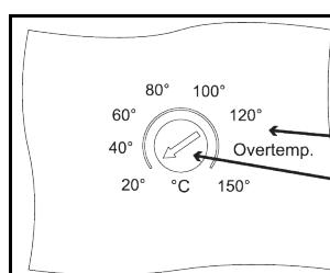
过温保护仅安装在具有加热装置的温度控制器中。监控预流温度是为了系统安全。同样在对系统加注导热液后进行设置。
