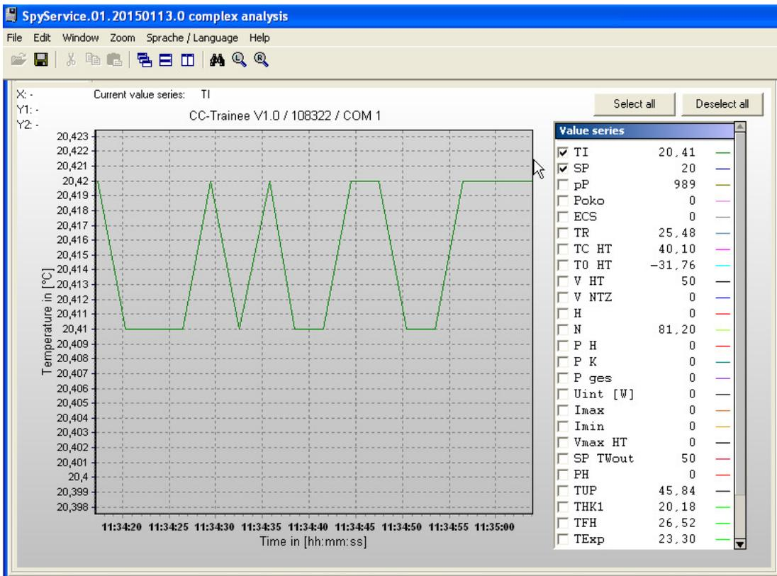
Mehrere Temperaturen werden im Diagramm angezeigt. Starten Sie das Gerät von 20°C zur niedrigsten Geräte Endtemperatur und wieder zu 20°C zurück. Danach beenden Sie das Logging und schicken die erstellte Datei via email zu Huber zur Untersuchung.
