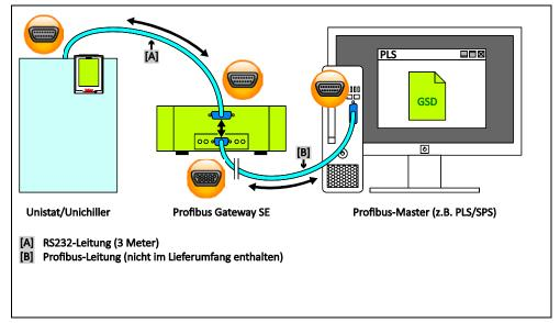
Profibus DP hat sich in industriellen Anwendungen durchgesetzt. Entsprechend ist die Dringlichkeit, Temperiergeräte so einfach, so flexibel und so prozessnah wie möglich, in Automatisierungslösungen einzubinden. Die sehr gute Standardisierung von Profibus DP führt zu sehr kurzen Inbetriebnahmezeiten im Feld. Das Profibus Gateway SE ist bei Anlieferung so vorbereitet, das die Einbindung über die Projektierungssoftware mittels der GSD-Datei sofort erfolgen kann.
